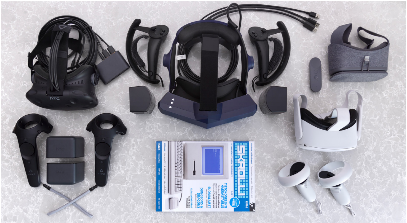
Modernien virtuaalisilmikoiden vanhuksia ja uutuuksia: Vasemmalla musta HTC Vive (2016) ohjaimineen ja majakoineen. Keskellä kokovertailuna A4-kokoinen Skrolli-lehti ja sen yläpuolella sininen Pimax Vision 8K X (2020) ohjaimineen ja majakoineen – Pimax käyttää Valve Index -varusteita. Oikealla harmaa Google Daydream View (2016) ja ohjain ylhäällä sekä valkoinen Oculus Quest 2 (2020) ohjaimineen alhaalla.
